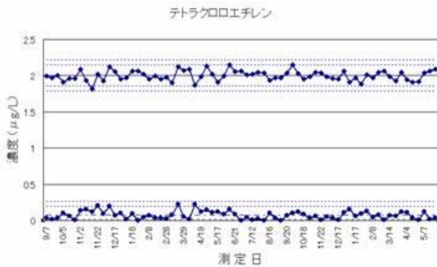
図5 コントロール試料を用いた品質管理 (コントロール試料の濃度 2 μg/L)
