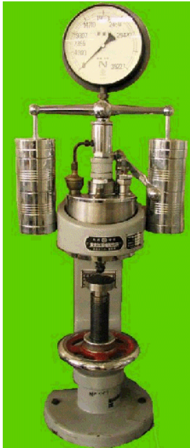
図1 ブリネル硬さ測定装置例
